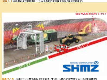
図表 1-15 「Safety 2.0 技術認証」を受けた、すり出し時の安全方策システム (筆者作成)
